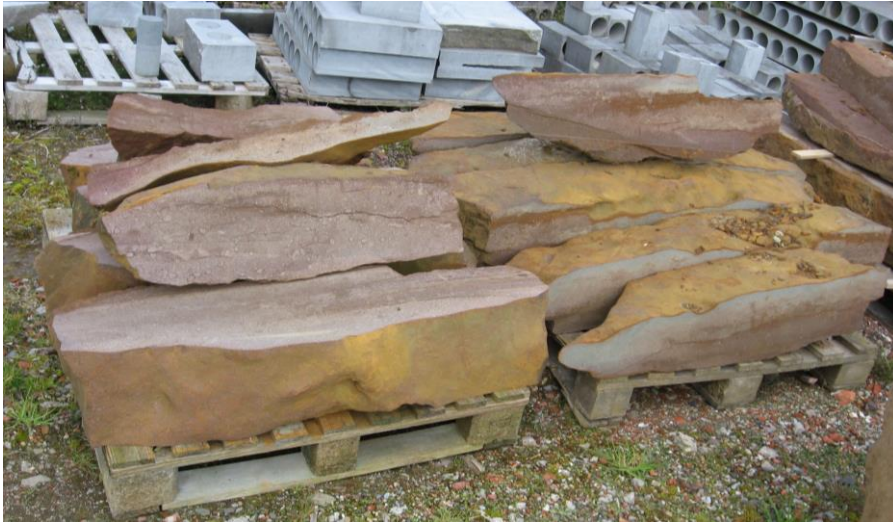
Siderietische ijzerzandsteen gevormd onder watertafel door neerslag van carbonaat dat nadien oplost en een rand van ijzercement achterlaat Platen uit Geel, Das Natuursteen, Molenstede
